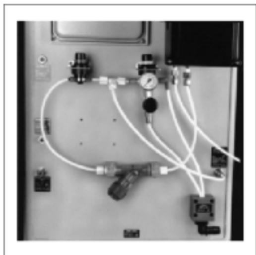
图 14 不锈钢样品压力调节工具包
