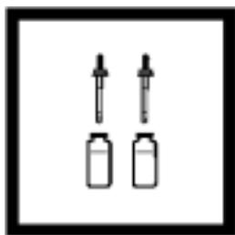
5. 在各样品池中加入 1.0 mL 钼钒酸盐试剂，摇晃以混匀。
