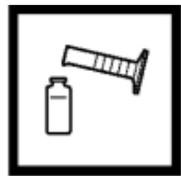
4. 用另一个 25 mL 刻度量筒来填充样品池，加入样品 25 mL (制备得到的样品)。
