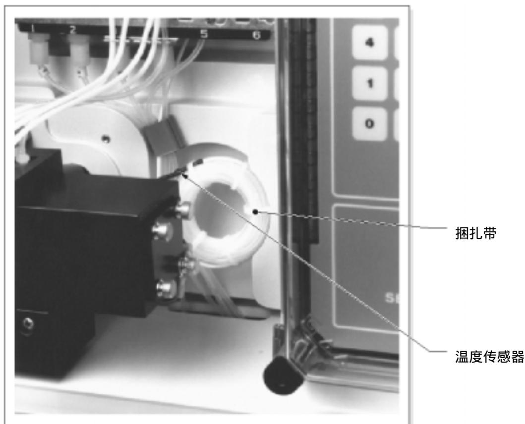
12. 选择管 1，修剪断多余的长度，安装一个新的 1/16 英寸穿透管式( thru-hose )倒钩组件来连接到#1 号试剂瓶管。将旧的装置从瓶管的顶部割掉，连接两根#1 号管。
